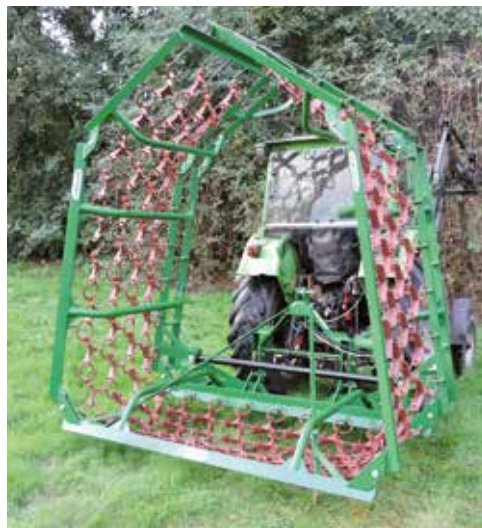
Grünlandegge 8,00 m, 4-reihig, hydraulisch klappbar
