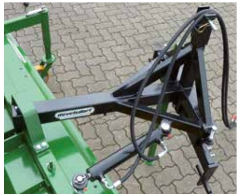
Hydraulische Schrägstellung
