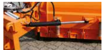
Hydraulische Schrägstellung
