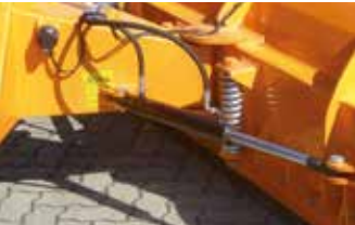
hydraulische Schrägstellung (optional)
